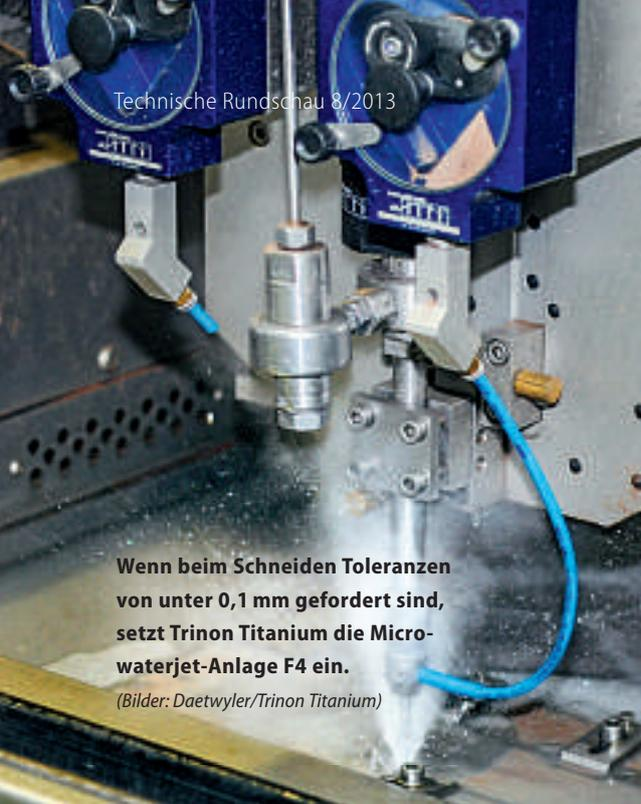
Wenn beim Schneiden Toleranzen von unter 0,1 mm gefordert sind, setzt Trinon Titanium die Micro-waterjet-Anlage F4 ein.
